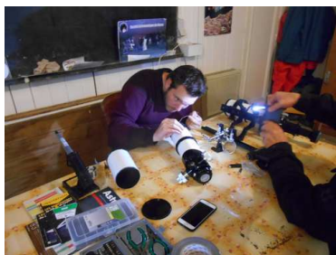
Olivier Alonso fabrique un système de chauffage automatique des lentilles sur une lunette
